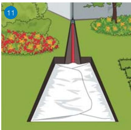
11 Klappen Sie das Vlies über dem Rigolenkörper zusammen. Überdecken Sie die Rigole mit Boden, legen Sie die Rasensoden wieder auf und drücken Sie sie leicht an. Natürlich können Sie auch die Fläche neu einsäen. In beiden Fällen wird gut gewässert, um ein schnelles, gutes Anwachsen zu erreichen.
