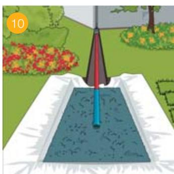
10 Falls Sie Kies verwendet haben, wird das Rohr auf dem Kiesbett verlegt.
