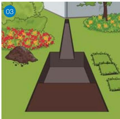
03 Heben Sie ihre Rigole aus. Überflüssiger Boden wird entsorgt oder an anderer Stelle im Garten untergebracht. Wann ist genug Boden entfernt? Sie müssen mehr ausheben als die Rigole benötigt, da Sie diese ja später noch mit etwa 20–30 cm Oberboden abdecken und vielleicht auch die Rasensoden wieder auflegen wollen – soviel müssen Sie jetzt zusätzlich abtragen! Bei einer 50 cm hohen Rigole mit 30 cm Überdeckung müssen Sie also 80 cm tief ausheben!
